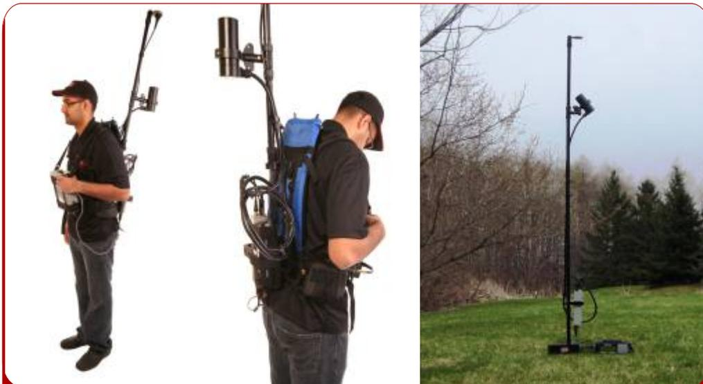
Magnetómetro de potasio (GSMP-35 v8,0) viene con la una consola robusta, mochila para los electrónicos, sensores de peso ligero y cables.
